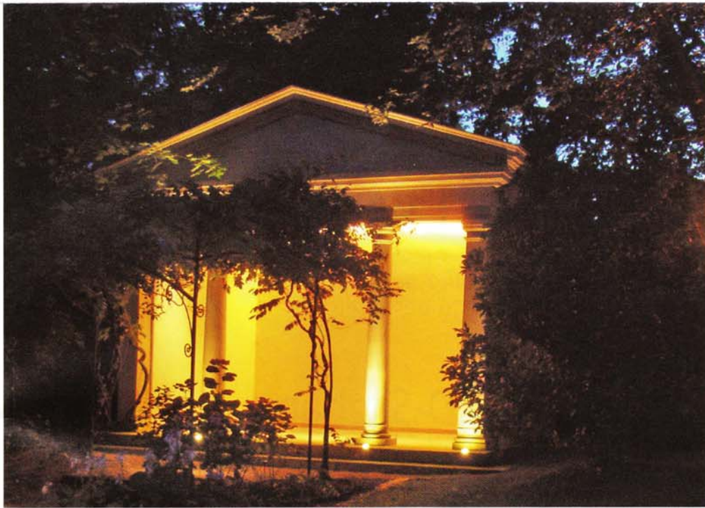
Der Sommerpavillon wurde mittels verschiedener Leuchten in Szene gesetzt – Strahler konturieren die Säulen, der gesamte Bau wurde von hinten beleuchtet, ein blauer Strahler erzeugt den Mondlichteffekt
